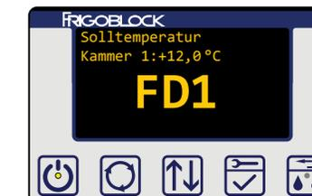
Durch mehrfaches Drücken der Taste kann zwischen den 5 hinterlegten Sollwerttemperaturen gewählt werden. Weiter bietet das Menü die Möglichkeit einen individuellen Sollwert einzustellen und die Kammer auszuschalten.
