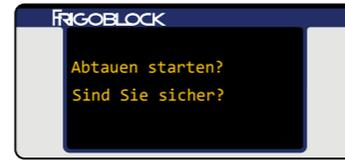
Es stellen sich die unter Betriebszustand Abtauen beschriebenen Ansichten in der Universalfernbedienung dar. Durch erneutes Drücken der Taste im Abtaumodus kann das Abtauen auch abgebrochen werden. Dazu die Abfrage „Abtauen abbrechen?“ Sind Sie sicher?“ mit der Taste bestätigen.
