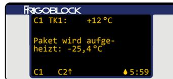
Ist eine andere als die abtauende Kammer angewählt so zeigt das Symbol im Display den Abtaubetrieb einer Kammer an.
