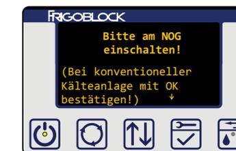
Jetzt kann die Kälteanlage mit mechanischem Thermostat über die zweite Fernbedienung ein- und ausgeschaltet werden. Weiter kann das Abtauen der Kälteanlage manuell gestartet werden.
